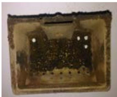
RUSZT KTÓRY WYMAGA CZYSZCZENIA
