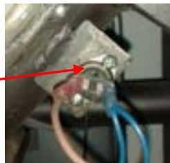
Czujnika detekcji cofnięcia się płomienia 105 °C.
