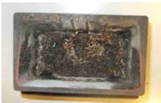
RUSZT KTÓRY WYMAGA CZYSZCZENIA
